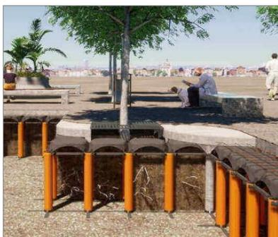
Fornitura e posa in opera di sistema per gestione di sviluppo dell'apparato radicale di nuove alberature o alberature trapiantate, con formazione di isola vegetativa tramite inserimento di elementi antiradici di varia tipologia. Il rifacimento dell'asfaltatura o della pavimentazione deve preferire soluzioni permeabili ed elastiche nei pressi degli alberi, evitando pavimentazioni discontinue come betonelle, piastrelle, ecc.
